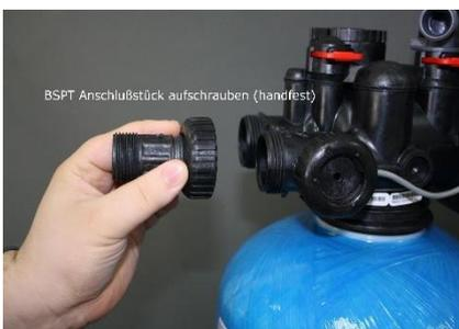
Auf der Rückseite des Steuerkopfes befinden sich zwei Öffnungen mit Außengewinde und Pfeilen, die Wassereingang- und Ausgang kennzeichnen. Auf diese Gewinde müssen zwei Übergangstücke geschraubt werden, die den Übergang auf europäische Gewinde (BSPT Gewinde) ermöglichen. Diese beiden Anschlussstücke befinden sich in einer Plastiktüte zusammen mit einer Beschreibung, wie die Einzelteile zusammengebaut werden. Auf der
