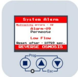
Lösung: Das System kann manuell durch Drücken der Reset-Taste oder durch automatischen Reset alle drei Stunden zurückgesetzt werden.
