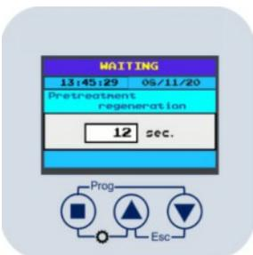
Der Zeitpunkt der Vorbehandlungsregenerierung ist unabhängig von den Reglereinstellungen. Wenn der Vorbehandlungs-Regenerationsmodus aktiviert ist, werden alle RO-Systemeinheiten ausgeschaltet und die Rohwasser-Speisepumpe eingeschaltet.
