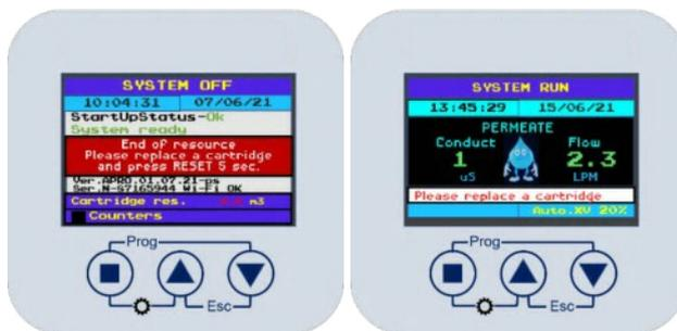
Lösung: Ersetzen Sie die Patrone und drücken Sie 5 Sek. lang auf RESET.
