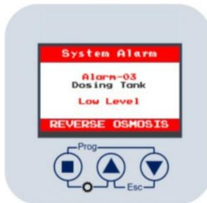
Lösung: Der Fehler wird behoben, wenn das Signal vom Niedrigwasserstandsensor empfangen wird. Überprüfen Sie andernfalls das Vorhandensein von Antiscalant und die Sensorfunktion.
