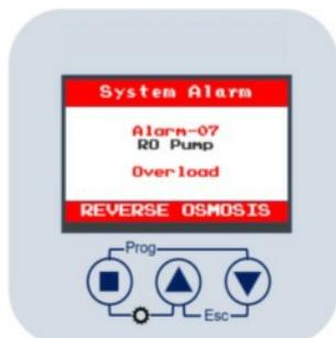
Lösung: Überprüfen Sie die Funktionalität der RO-Pumpe P-01 und des Überlastschalters (im Schaltkasten).
