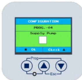
Wenn schnell eine große Menge an gereinigtem Wasser bereitgestellt werden muss, kann ein druckloses Umkehrosmose-Wasserversorgungssystem angeschlossen werden (P-04). Das Umkehrosmosesystem füllt den zusätzlichen Tank mit RO-Wasser bis zum angegebenen Füllstand (LLS-03).
