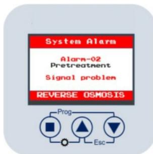
**Lösung:** Überprüfen Sie die Funktionalität der Vorbehandlungsausrüstung, des Kabels der RO-Systemsteuerung und der Steuerung des Vorbehandlungssystems.
