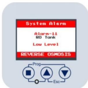
Lösung: Der Fehler wird behoben, wenn ein Signal vom Niedrigwasserstandssensor empfangen wird (wenn das Permeat im Tank vorhanden sein wird).
