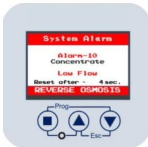
Lösung: Das System kann manuell durch Drücken der Reset-Taste oder durch automatischen Reset alle drei Stunden zurückgesetzt werden. Überprüfen Sie die Funktionsfähigkeit des Konzentratsensors und des automatischen Konzentratventils XV-04.
