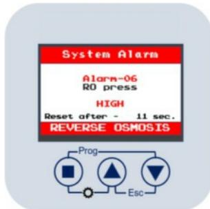
Lösung: Der Fehler kann manuell durch Drücken der Reset-Taste oder durch automatischen Reset alle drei Stunden behoben werden. CIP durchführen oder Membran wechseln, HPS-02 Funktionalität prüfen.
