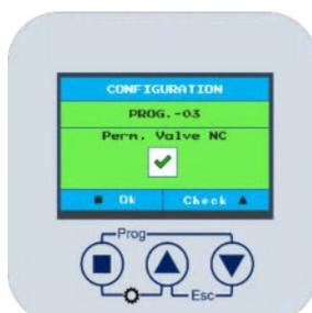
Vorhandensein eines primären Permeat-Drainageventils (XV-02). Das Ventil schaltet ein, wenn der eingestellte Wert der elektrischen Leitfähigkeit des Produkts überschritten wird.
