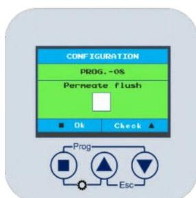
Aktiviert die Membranspülung mit Permeat, wenn sich das System im Stand-by-Modus befindet. Permeat wird durch das Ventil XV-05 geliefert.
