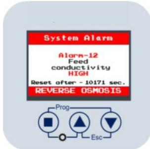
Lösung: Das System kann manuell durch Drücken der Reset-Taste oder durch das automatische Zurücksetzen alle drei Stunden zurückgesetzt werden. Überprüfen Sie die Rohwasserversorgungsqualität, Funktionalität von ECT-02 und Vorbehandlungssystem.
