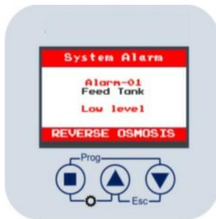
**Lösung:** Der Fehler wird behoben, wenn das Signal vom Niedrigwasserstandsensoren empfangen wird. Andernfalls RO-Wasserversorgung und LLS-01-Funktion prüfen.
