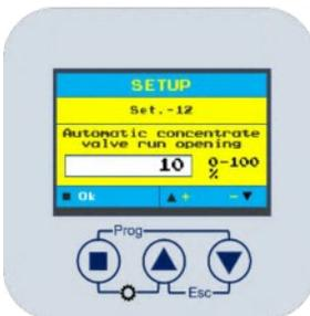
Einstellen des Öffnungsprozentsatzes des Konzentratventils während des Betriebs (Einstellen der gewünschten Rückgewinnung des Systems).
