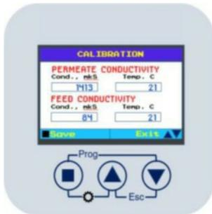
Platzieren Sie den Permeatsensor in 84 mKS-Lösung und speisen Sie den Sensor in 1413 mKS-Lösung. Wenn die Werte gleich sind (bzw schließen) zu den Standardeinstellungen, drücken Sie SPEICHERN Taste. Wenn nicht, wiederholen Sie die Kalibrierung (Schritte 4-11).
